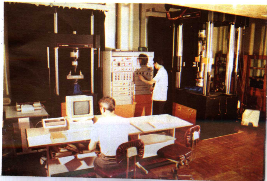
学校测试分析中心的电液材料力学伺服试验机实验室。
