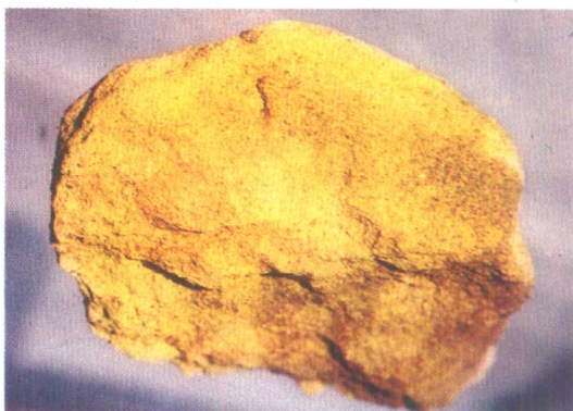
照片26 \times 0.5 钒钙铀矿, 浅黄色粉末状, 充填在砂岩胶结物中
