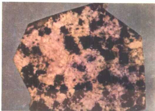
照片 4 光片照像 原大 方钍石，黑色呈浸染状产 于浅色大理岩中
