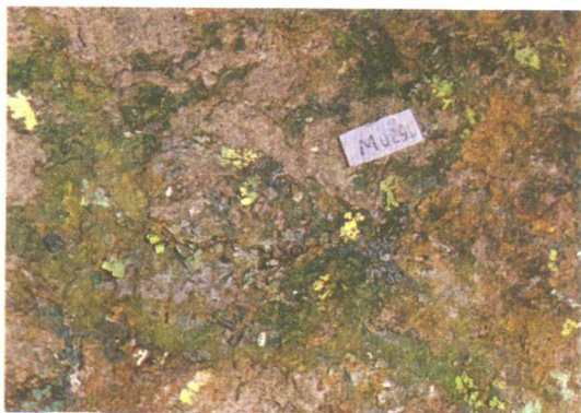
照片21 \times 0.7 铜钨云母的绿色片状晶体
