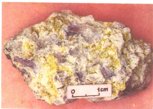
照片23 \times 0.83 芙蓉铀矿 (磷铝铀矿), 浅黄色, 隐晶质集合体
