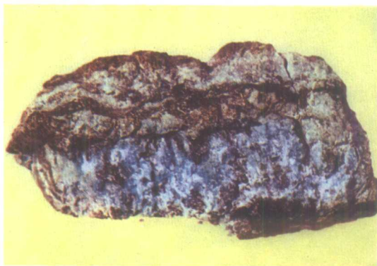
照片36 \times 0.6 含铀水铝英石，蓝色和蓝绿色，充填在含炭硅岩裂隙中
