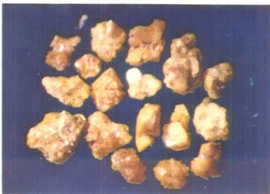
照片28 双目镜 \times 40 钒钼铀矿的菱形板状晶体 集合体颗粒
