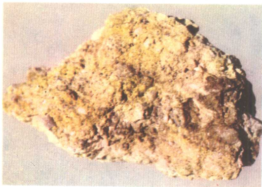
照片13 \times 0.7 花岗质砂岩孔隙中充填的 黄色粉末状磷铀矿
