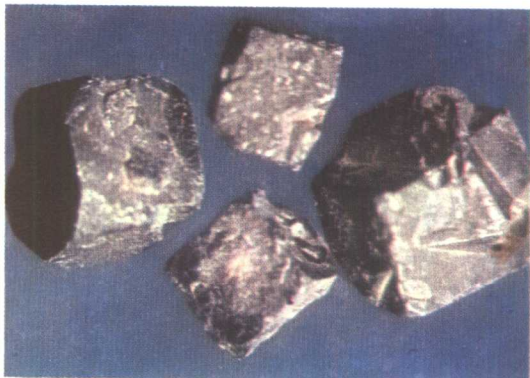
照片 3 双目镜 × 6 晶质铀矿的立方体晶形和 穿插双晶
