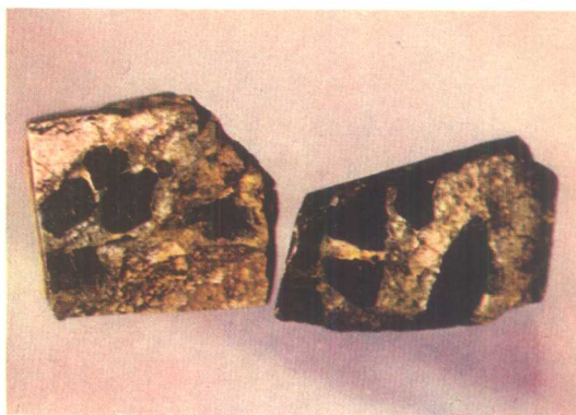
照片 2 光片照像 × 0.7 晶质铀矿，黑色晶体
