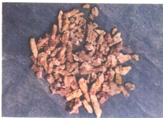
照片10 双目镜 原大 铀钍石的柱状晶体
