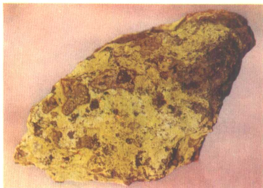
照片34 \times 0.7 水硫铀矿，黄色，粉末状，充填在砂砾岩的颗粒孔隙之中
