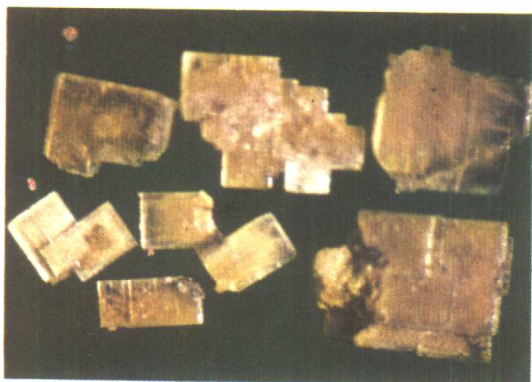
照片19 双目镜 \times 30 铁铷云母晶片常有浅黄色 透明的边缘
