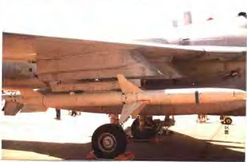
→掛載在海軍 EA-6B 電戰機上 的 AGM-88C 高速反輻射(雷達) 飛彈。
