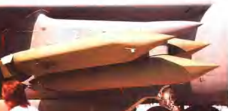
←掛載在 B-52H 翼下內側掛架的 AGM-129 先進巡弋飛彈，其射程超過 3300 公里，並具有匿蹤能力。
