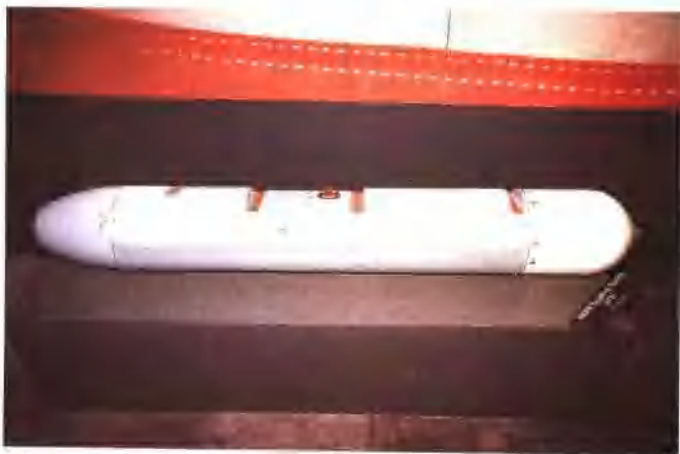
→掛載在海軍 EA-6B 電戰機上 的 AGM-88C 高速反輻射(雷達) 飛彈。
