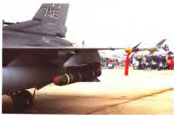
▶掛載於 F-16 翼下的 AGM-65G 紅外線成像 小牛飛彈。
