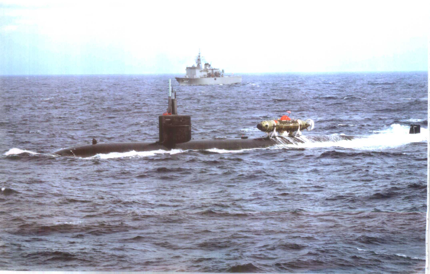
洛杉矶级“拉霍亚”(La Jolla, SSN-701)号 驮载着DSRV-2号救生潜艇进行救生演练
