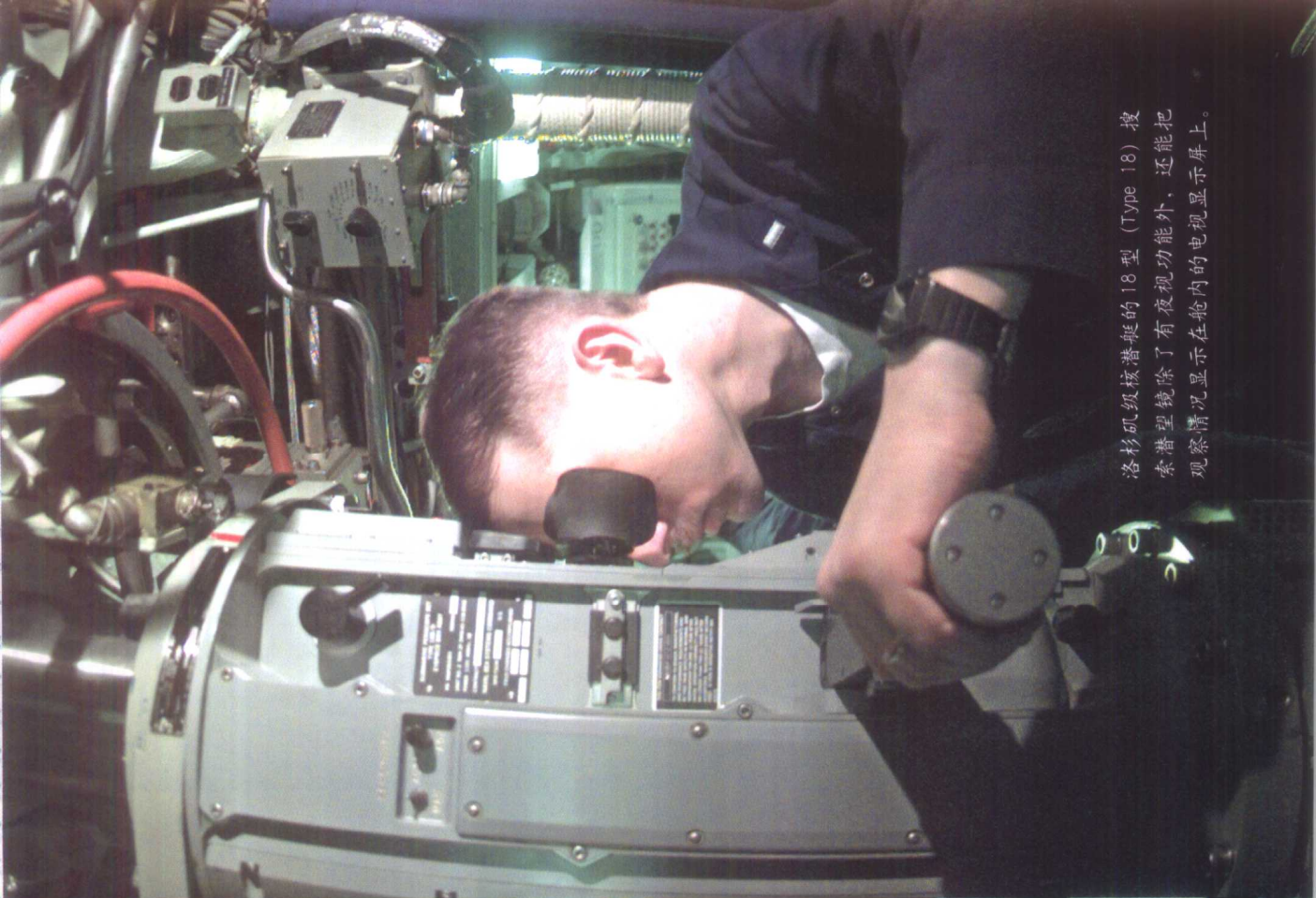
洛杉矶级核潜艇的8型 (Type 8) 攻击潜望镜位于左舷
