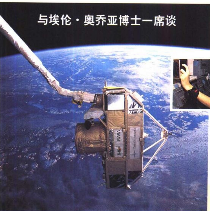
◀ “亚特兰蒂斯号”航天飞机上的 RMS 机械臂抓住了一个卫星
