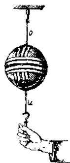
第 287 圖 顯示靜止質量之慣性，具有抗拒劇變能力。
