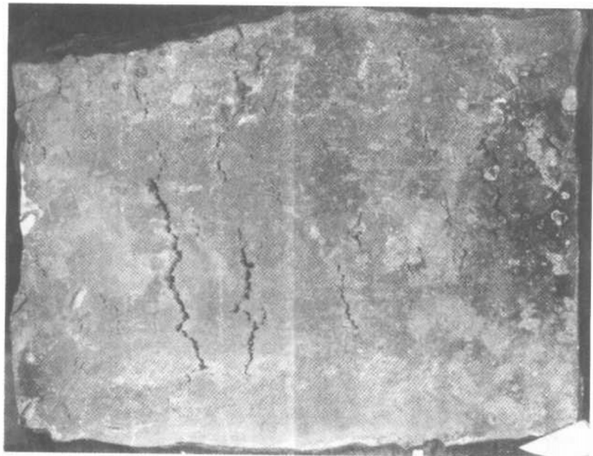
图 1-17 GCr15 钢锭内部严重过烧,表面出现粗大裂纹
