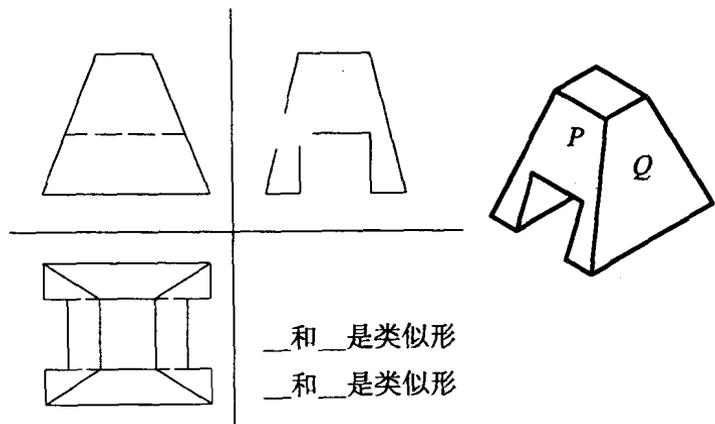
(4) 自选平行面、垂直面和一般位置面各一个, 分别在立体图和投影图中加深并标注字母, 填写平面名称。
