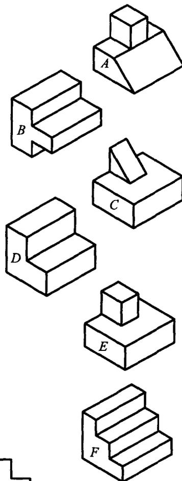
2-2 参照物体的立体图, 改正投影图中存在的错误, 并用粗实线加深正确的三面投影图。
