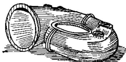
图 9-5 铸铁蜗壳全貌
