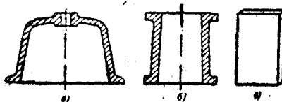
图1-3 零件在铸型中的位置。
