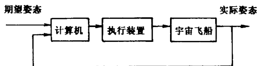
图 1.8 宇宙飞船姿态控制系统方块示意图
