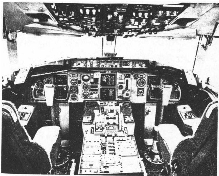
飛機駕駛艙內部。自動飛行控制系統包含許多數位電子電路。
