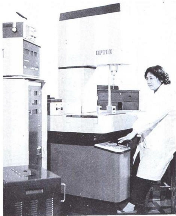
△ 计量人员用um m 500型三座标 万能测量机检测透平叶片型线 △
