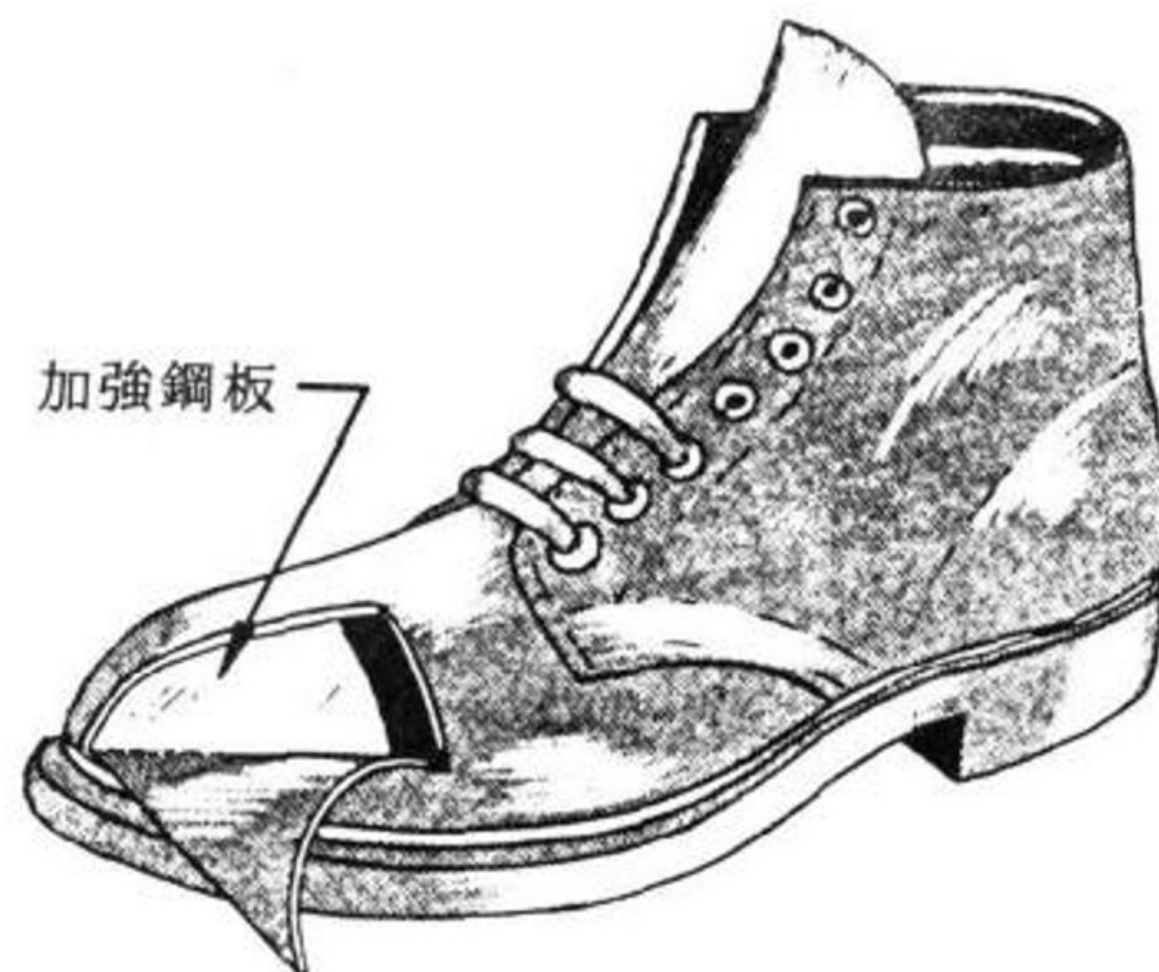
圖 1.2 嵌有加強鋼板的安全鞋
