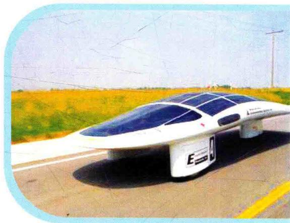
**小提示** 太阳能汽车是采用太阳能电池作动力源的汽车。根据光和电的转换原理，能立即产生直流电，供给直流电动机，驱动汽车行驶。
