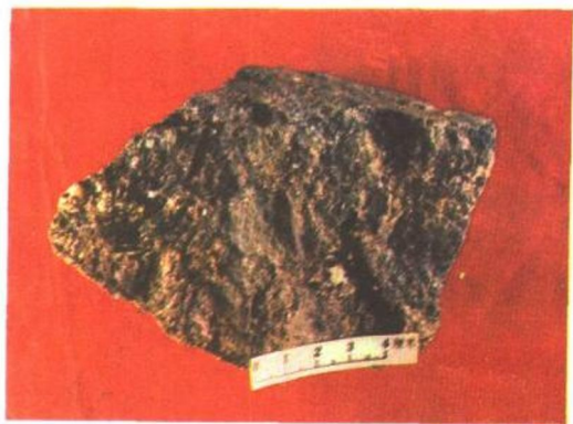
照片3 碳酸盐化细脉浸染状汞矿石。红色细粒辰砂浸染于白色脉石中。 (务川 \epsilon_1 层汞矿床)
