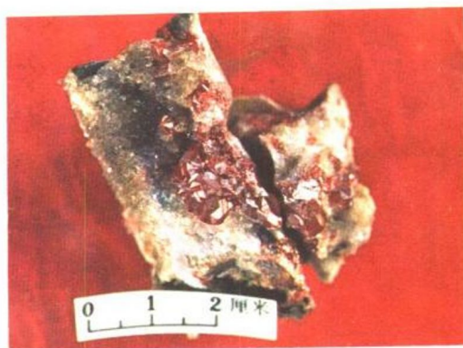
照片 1 强硅化微石英岩汞矿石。白色为糖粒状石英，辰砂呈六方晶形产出。 (万山汞矿 C_2^5 层汞矿床)
