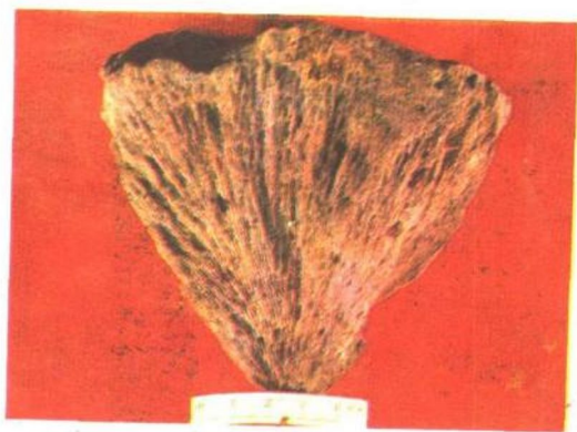
照片4 放射状方解石汞矿石暗红色粗粒辰砂浸染其中 (万山汞矿 \epsilon_2 层汞矿床)
