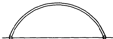
图 7 钢管架无立柱中棚
