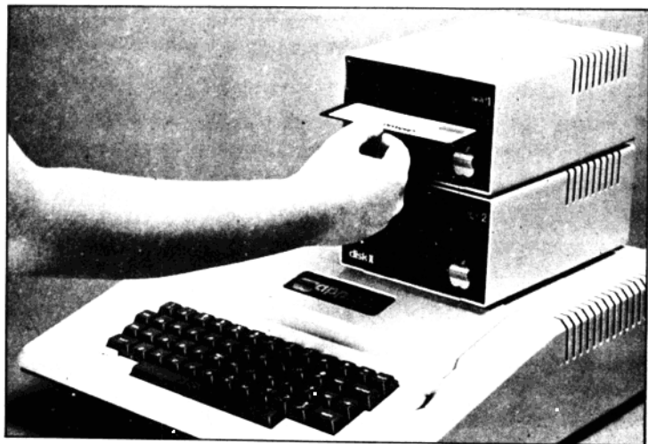
圖 2-3 將磁片插入 DISK II 內
