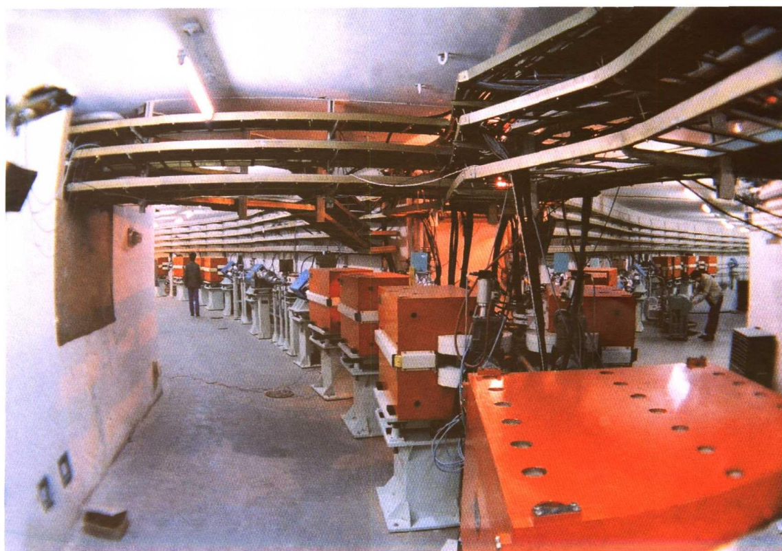
对撞机运输线正负电子分叉区
