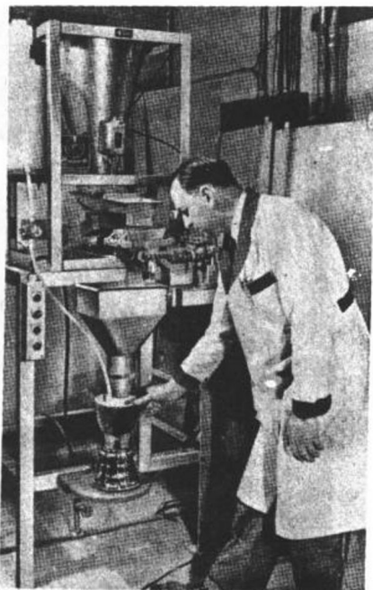
圖 1 - 1 自動混和機器將耐火泥粉及結合料混合，並使成膠體狀，以便製作模子。
