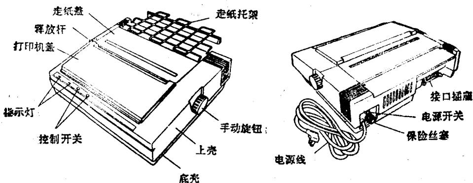
IBM 80 CPS 打印机是每秒钟打印 80 个字符、双向打印、字符可变、多功能的点阵式打印机。
