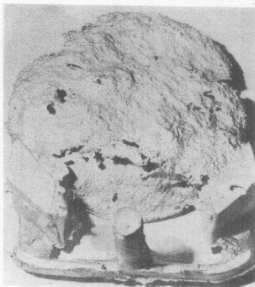
图7.8 压铁碰塌了砂型
