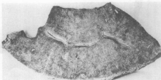
图9.7 因碳素材料或抗膨胀材料不足而造成的沟槽缺陷 (清理前沟槽上有一块结疤)
