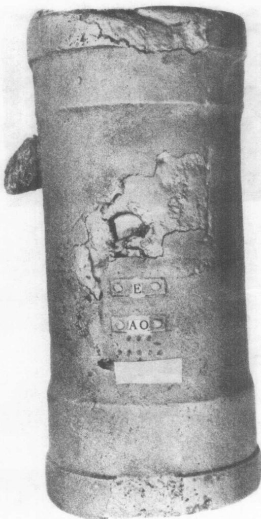
图11.6 因机器上的油脂（外来物质） 落入面砂而产生的气孔缺陷
