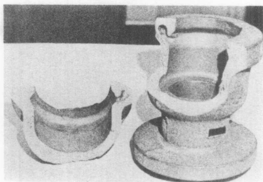
图11.11 型芯涂料层的表面破损，气体滞留在铸件的厚截面中
