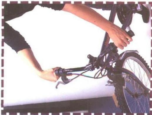
转动左手的变速手柄,你可以转换轮盘,转动右手的手柄,可以转换飞轮。转动每一档轮盘(大、中、小,下图)时,你都可以调节右手的飞轮。
