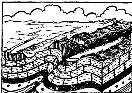
3 岩层受力继续加强发生断裂
