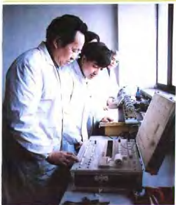
汽机室技术人员进行消除汽轮机振动的试验研究
