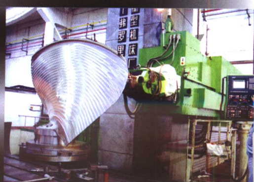
五轴联动数控铣镗床加工水轮机转轮叶片
