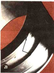
图 20 所示的疲劳损伤是由于在保管过程或安装时受到撞击造成的。撞击留下的凹坑可引起早期疲劳。
