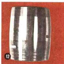
滚动体可能表面变光泽(图 12)或者滚珠被焊到圈上(图 13)。
