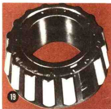
图 19 中的保持架因为装配时未使用正确的工具受到损伤。很明显, 是用一根铁棍或冲子顶在保持架上而不是顶在内圈的端面上, 将内圈装到轴上去的。
