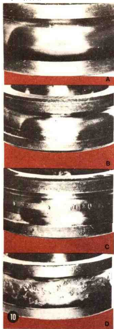
滚动体可能表面变光泽(图 12)或者滚珠被焊到圈上(图 13)。
