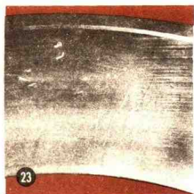
图 23 指出用来安装外圈的铁棍或工具是如何滑脱并损伤滚道表面的。
