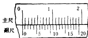
图 1-19 0.05mm游标卡尺的刻线
