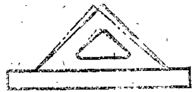
图 1-5 45^\circ 角的检验方法
