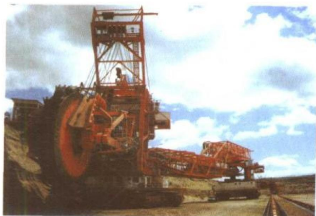
90年代初,沈阳重型机械集团有限责任公司与德国塔克拉夫公司合作为内蒙古平庄矿务局元宝山露天煤矿制造的大型连续开采成套设备。图为中方生产的3600m 3 /h斗轮挖掘机
