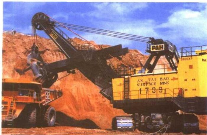
80年代,第一重型机器厂和湘潭电机厂引进美国P&H公司技术合作制造的2800XP型挖掘机,斗容23立方米,在平朔露天煤矿使用(两千万吨级露天矿成套设备)
