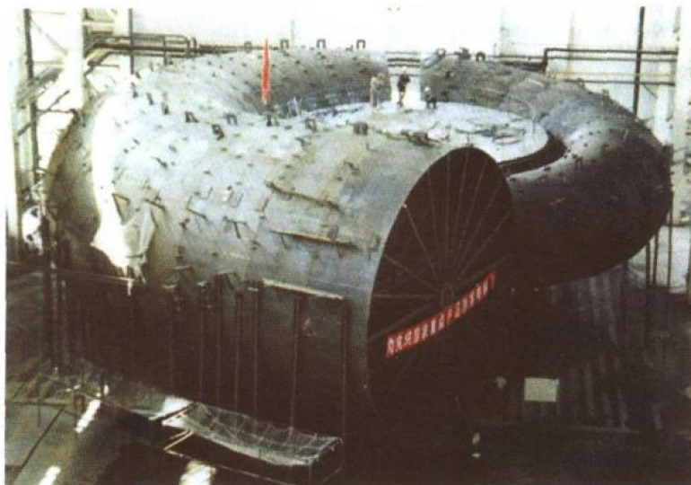
80年代，哈尔滨电机厂为岩滩水电站制造的第一台水轮发电机组的转轮直径8米、蜗壳进口直径10.8米的蜗壳进行预安装
