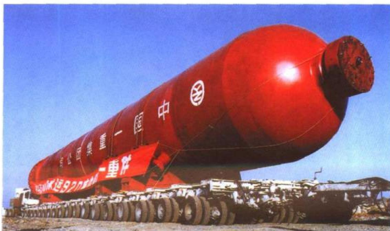
90年代，第一重型机械集团公司为齐鲁石化公司制造的首台千吨级热壁加氢反应器
