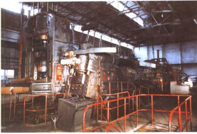
1967年，沈阳重型机器厂为西南铝加工厂研制的12500吨有色金属卧式挤压水压机（九大设备之一）
