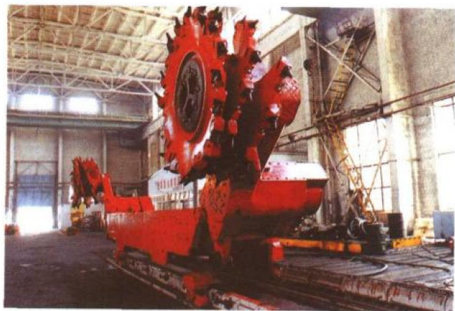
90年代中期,太原矿山机器集团有限公司研制的我国首台3.3kV大功率交流电牵引采煤机,部分技术达国际90年代初水平,该机已在兖州、大同煤矿使用,日产达1.5万吨,是煤矿高产高效综采机械化主要设备之一
