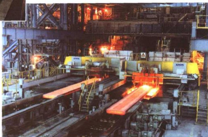
90年代初，中国第一重型机械集团公司为宝山钢铁公司制造的1450毫米板坯连铸机
