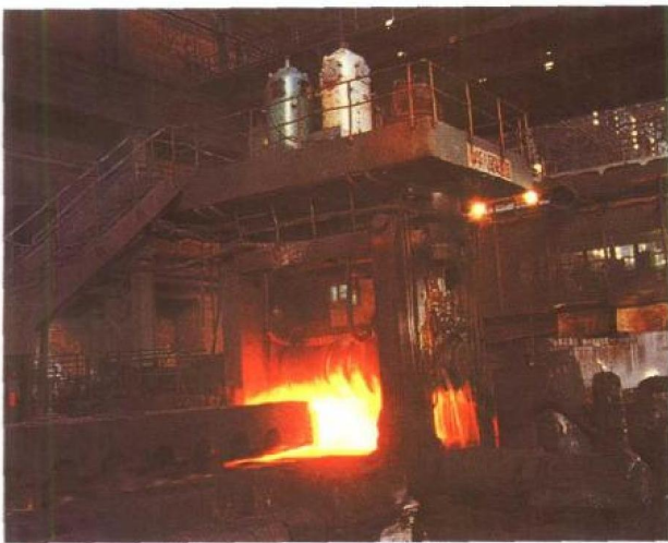
50年代末期,第一重型机械集团公司为包头钢铁公司制造的第一代1150毫米方坯初轧机
