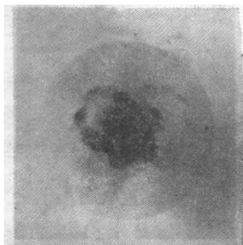
图 1.3 五水硫酸铜晶体的透射劳厄花样
