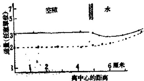
图 2. 空隙端部的穿流效应的比例。 实线：开口空隙，虚线：在二端用铜片封死
