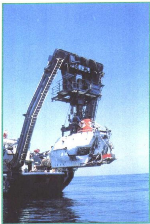
▲ 海上作业船正在将完成深海考察的阿尔文号潜水器起吊上船。
