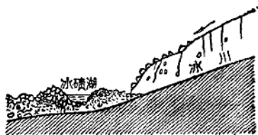
冰川末端冰碛物堆积剖面图
