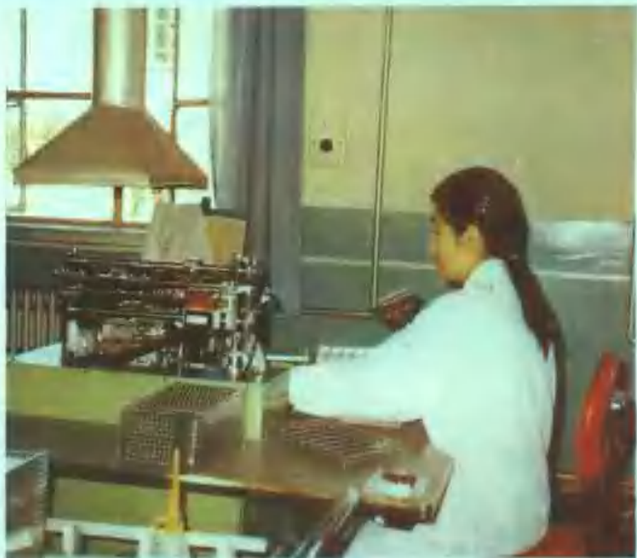
12 北京广播电视配件七厂中频变压器焊接工序
