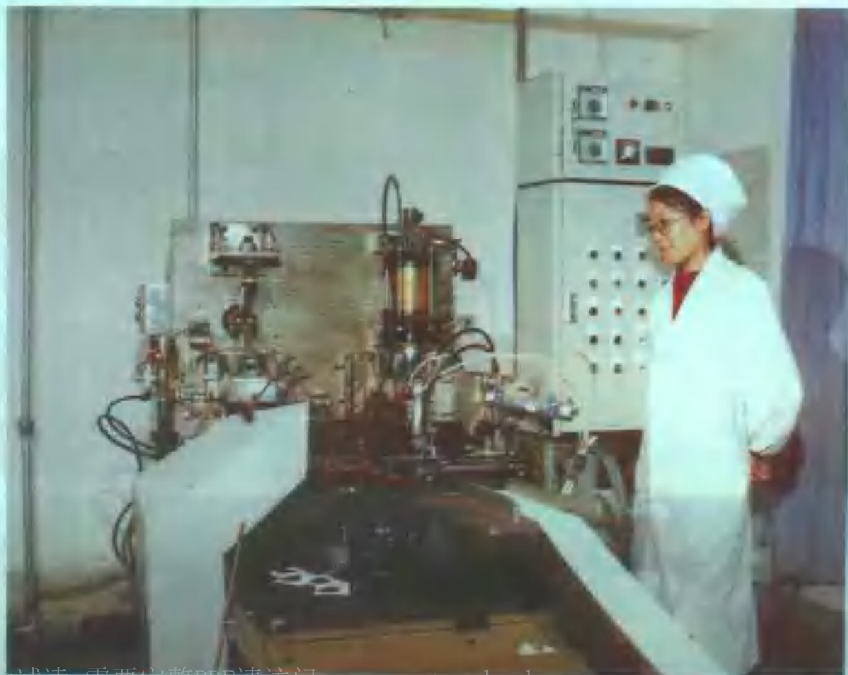
13 北京市电声器材总厂扬声器定芯支片生产设备
