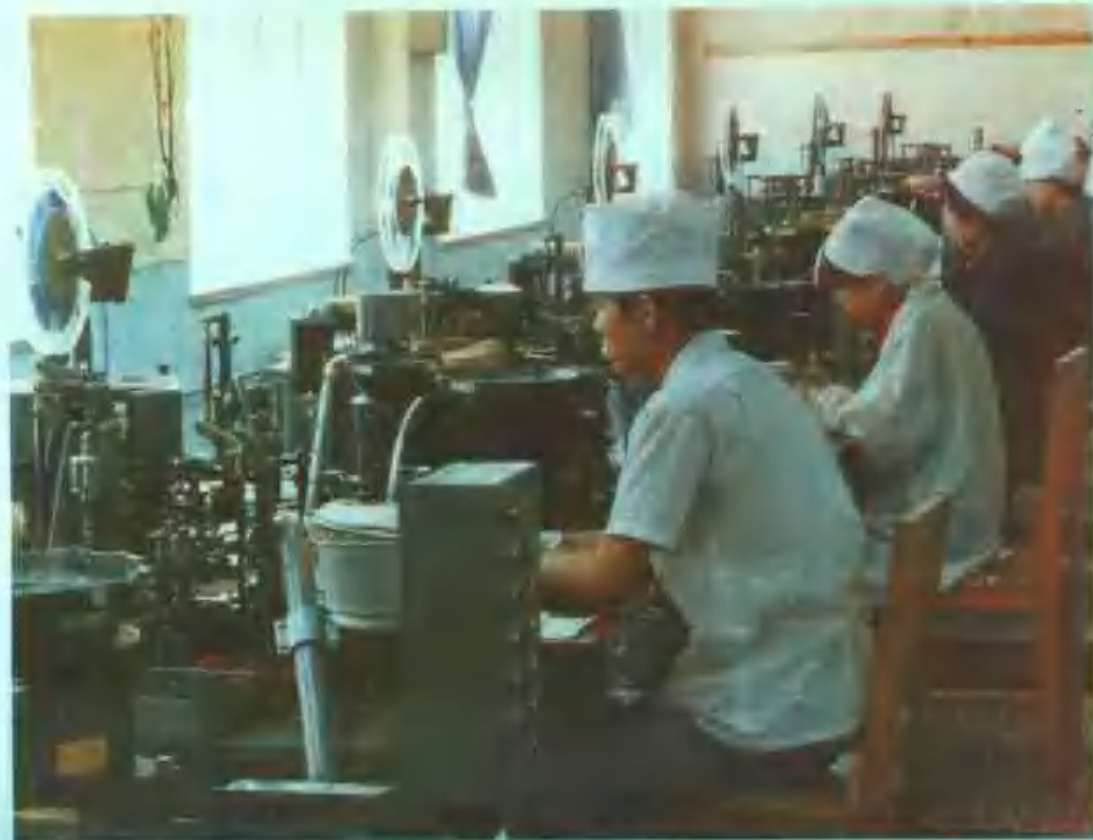
8 北京市无线电元件十厂电解电容器半自动生产线
