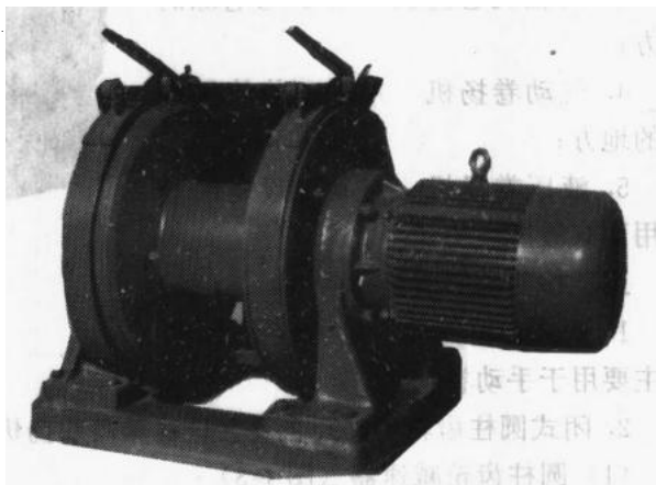
图 1-7 3K 行星齿轮传动卷扬机
