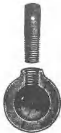
第345圖 鐵彈中之水結冰時，會使鐵彈炸裂。
