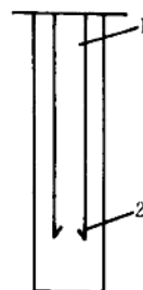
图 1—26 笼统式注水管柱
