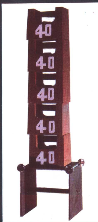
ZHK 组合扣受压试验 (受压 100 公斤力)
