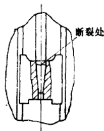
图12-2-22 锤杆从锥度部位断裂
