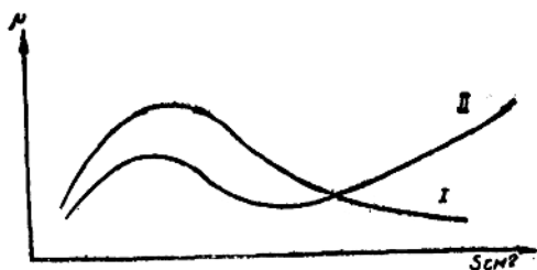
圖 1 鑽刃材料沿岩石運動的磨擦系数與鑽刃磨鈍关系圖
