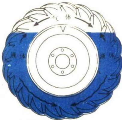
拖拉机轮胎的内胎中注有液体作为轮子的配重
