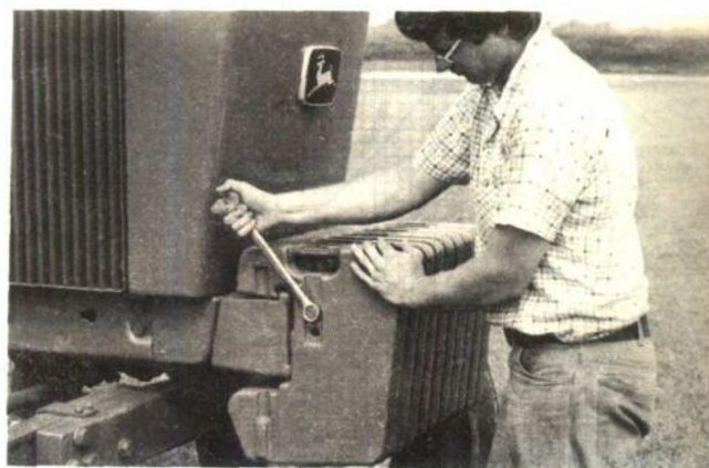
图 21 — 农用拖拉机上前端的铸铁块
