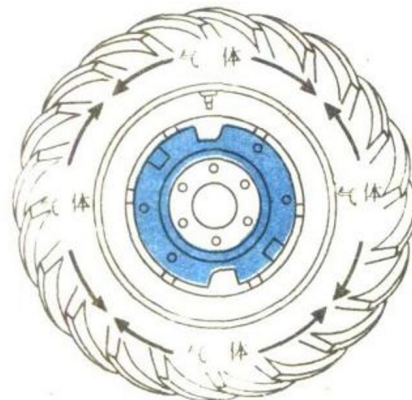
轮子上装有可拆卸的铸铁配重
