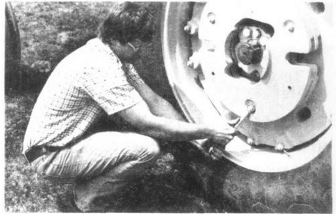
图 15 — 高档操作的农用拖拉机的配重——通常 4 英里/小时或者更高
