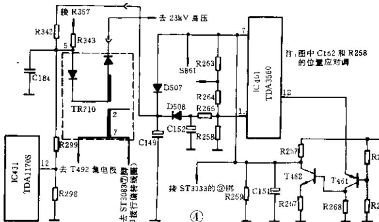
采用单稳态电路是为了防止偶然打火，该电路的单稳定时时间约2.45秒。当T482截止时，其集电极电压不再为0.3V（饱和压降），而应为1V。T481便从截止变为导通，促使T491饱和，T492不工作，于是高压不能产生，达到保护的目的。约经2.45秒后，由于C131的放电作用，电路便自动恢复正常工作状态。
