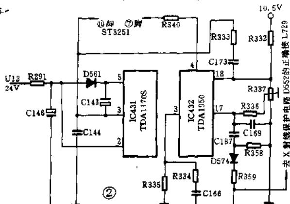
出, 通过 C166、R334 后, 由 TDA1950 的③脚输入, 混合为复合沙堡脉冲后从 TDA1950 ①脚输出, 通过 R340、ST3251 的⑦脚, 维修开关 S861、R260 供给色解码集成块 TDA3560 的⑧脚, 这个信号在正常状态下, 以脉冲形式通过一系列直接耦合放大和变换后加入视放电路控制显象管阴极电平, 达到消隐的目的。当场扫描电路有故障(如场停振), 场消隐脉冲也就消失了, 此时, 消隐控制电路将会输出一个直流电位, 控制显象管阴极, 使之无光栅, 保护了显象管, 排除了普通电视机屏幕上通常会出现一条水平亮线状态而烧伤显象管的危险。同理, 若行扫描电路有故障, 从 IC432(TDA1950)①脚送出的“城堡”信号则会失常, 此时显象管同样不能发光。实际维修过程中发现, 若屏幕无光栅而伴音正常, 其主要故障为 R291 烧坏, IC431(TDA1170S)损坏。此
