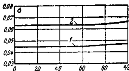
圖 7 當水力發電廠經雙回路 220 千伏(曲綫 1)及 110 千伏(曲綫 2)的 5 根導綫運行於無限大容量的母綫上時， \sigma 值隨中性點不接地的輸電變壓器的多而變化的關係曲綫
