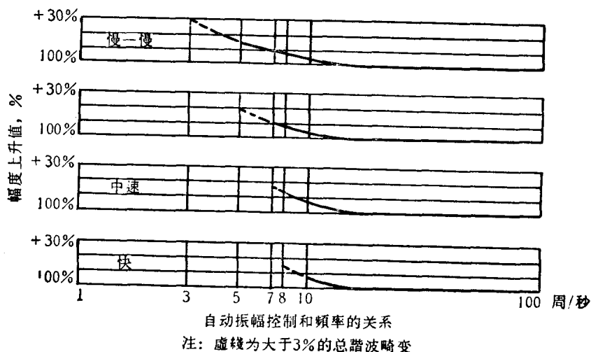
图 11 包括低频效应的地震放大器的自动振幅控制
