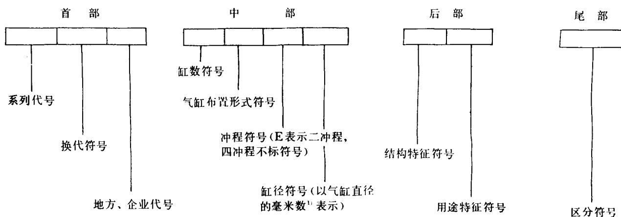
注：1) 气缸直径的毫米数取整数。
