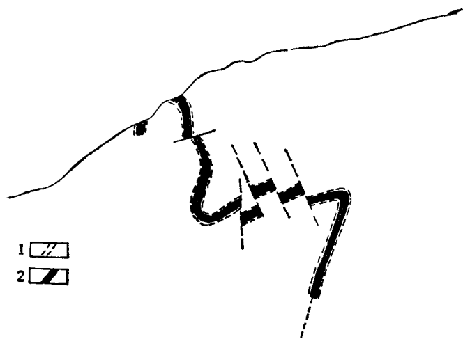
图1 巴特矿床地质示意剖面 1. 纯橄岩矿衣; 2. 铬铁矿矿体。
