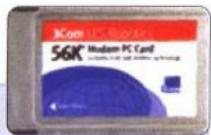
不同于台式计算机，笔记本电脑上使用的是 Modem PC 卡。使用时，将 Modem PC 卡插入笔记本电脑的 PC 卡插槽即可。
