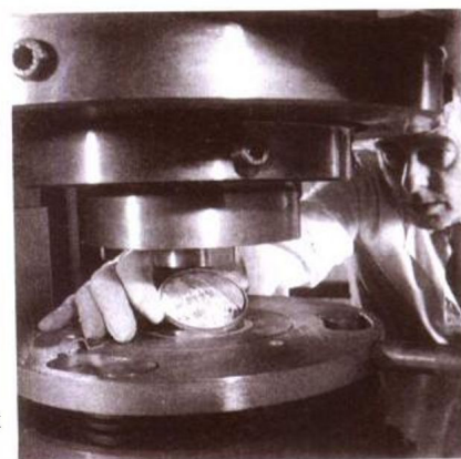
图 1-15 在 600 吨压力下能冲压出最大直径 75 毫米的硬币
