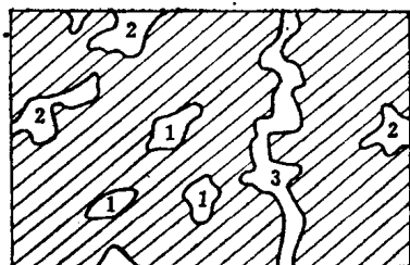
图 1-2 耐火制品中气孔类型 1—封闭气孔；2—开口气孔；3—贯通气孔
